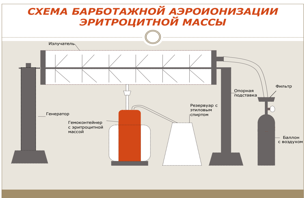
Рис. 1. Схема аппарата для барботажной аэроионизации крови (эритроцитной массы) (сокр.: БАИК).
